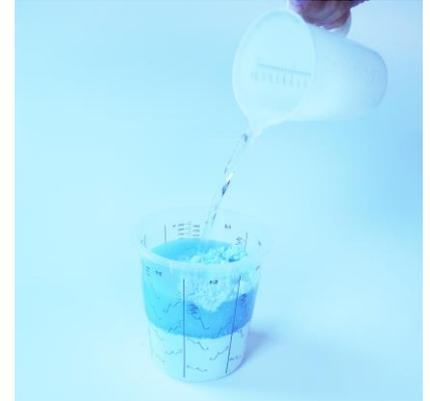
**Abb. 1:** Ein Messbecher, gefüllt mit 300 g 3-D Gel. Wasser wird im entsprechenden Verhältnis der Gewichtsanteile zugegeben. 1 Teil Pulver : 5 Teilen Wasser.
