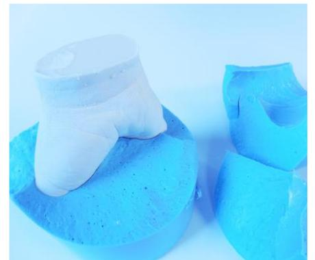
Abb. 6: Die Silikonhand wird aus dem 3-D Gel genommen; in diesem Fall besteht die Gießmasse aus Acrylic One.
